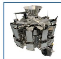
scaricato un peso approssimativo. I cestelli di predosaggio alimentano a loro volta i cestelli di pesatura supportati da celle di carico. Da questi in combinazione deriverà la pesata.
