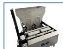
Il prodotto viene collocato all'interno della tramoggia di carico la quale riempie i canali sottostanti, che tramite vibrazione
